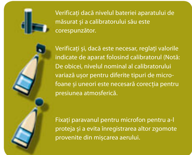
Figura 2.10 Pregătirea măsurării: instrucțiunile producătorului
