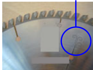
Figura 4.9 Tăierea lemnului – Utilizarea discurilor silențioase (© prin amabilitatea INRS – Franța)
