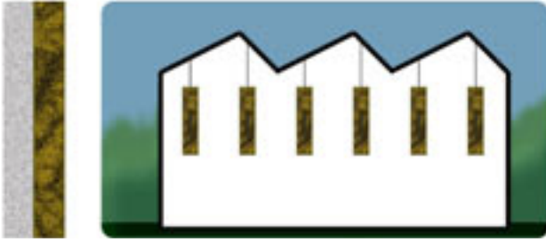
Figura 3.6 Materialele poroase pot fi amplasate pe pereții atelierului sau utilizate ca „ecrane deflectoare” suspendate de plafon pentru a atenua sunetul de înaltă frecvență
