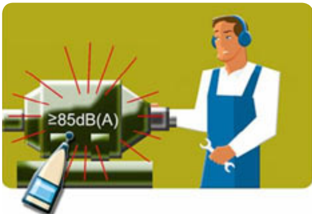
Figura 5.2 Expunerea la zgomot atinge sau depășește valorile superioare de expunere care declanșează acțiunea; lucrătorii trebuie să utilizeze mijloace de protecție auditivă
