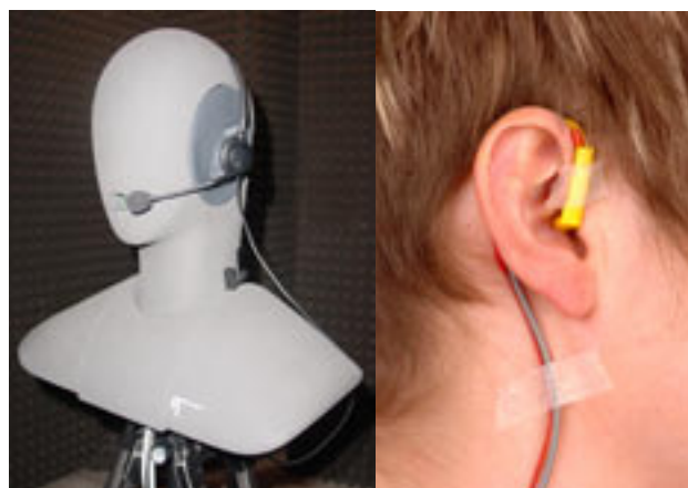
Figura 2.13 Măsurarea zgomotului la nivelul urechii prin metodele HATS și MIRE (Fotografie © și prin amabilitatea Comitetului Executiv pentru Sănătate și Securitate – Marea Britanie) Corect: Simulator pentru cap și trunchi (sursa HEAD Acoustics GmbH, Germania) Părăsit: MIRE
