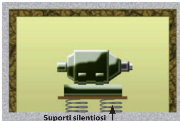
Fig. 4.14 Izolarea echipamentului zgomotos
