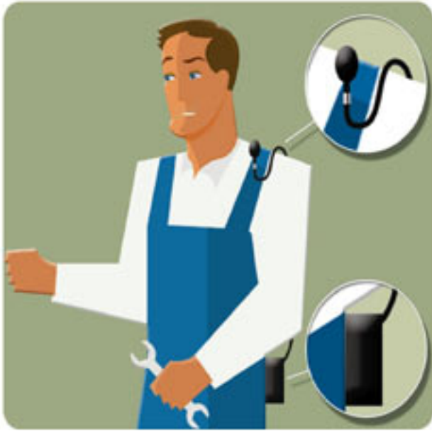
Figura 2.12 Microfonul dozimetrului poziționat pe umăr
