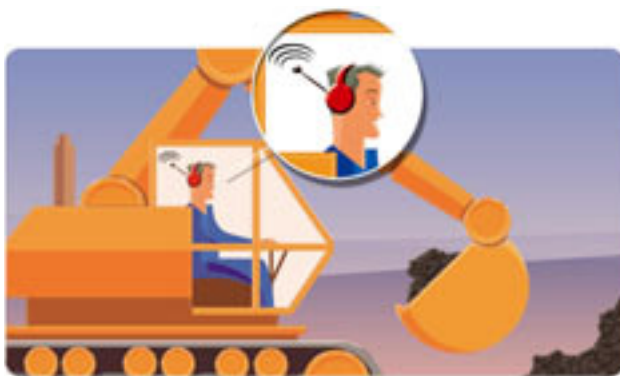
Figura 5.11 La un post de lucru în care comunicarea este necesară, un lucrător folosește antifoane externe prevăzute cu sisteme electronice de comunicare
