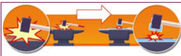
Figura 4.8 Surse cu transmitere solidă: se acționează asupra forțelor sau structurii echipamentului
