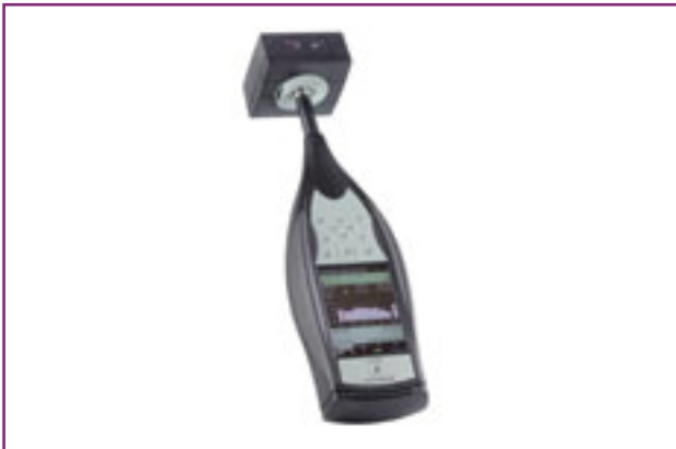
Figura 2.5 Sonometru cu calibrator de sunet (Fotografie © și prin amabilitatea Bruel & Kjaer)
