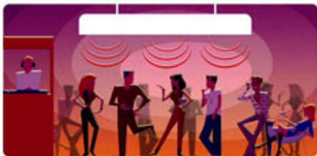
Figura 8.1 Discotecă cu plafon acustic și cu mai multe difuzoare încorporate, înlocuind cele două difuzoare principale
