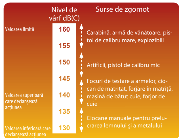
Figura 2.3 Nivelurile de vârf ale presiunii acustice de vârf tipice pentru sursele de zgomot cu caracter de impuls
