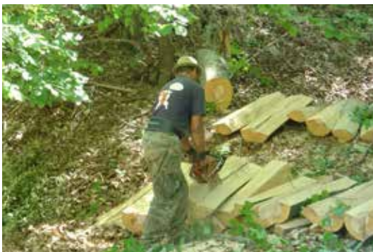
Operator de ferăstrău cu lanț fără formare de specialitate și fără echipament individual de protecție
